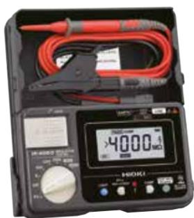
Identifica con rapidità quale pannello/stringa sta degradando il proprio livello di isolamento, ponendo l'inverter in "allarme isolamento". Due tensioni di prova 500/1000V con comparatore per esito immediato OK/NO. Idoneo per eseguire la verifica dell'isolamento su impianti elettrici AC "tradizionali". **Utilizzabile alla luce del sole, anche in presenza di tensione.**
