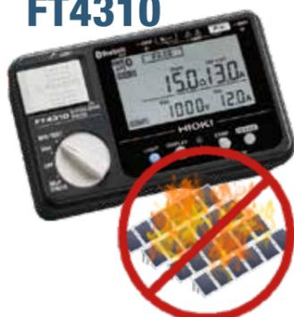
Indispensabile per le attività di manutenzione preventiva e di ricerca guasti sugli impianti fotovoltaici. Identifica istantaneamente i diodi di bypass danneggiati, alla luce del sole e senza oscurare i pannelli. **Permette di prevenire condizioni di surriscaldamento localizzato (hot-spot) con conseguente danneggiamento del modulo dovuto al diodo di bypass interrotto, primaria causa di incendio negli impianti fotovoltaici!**
