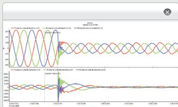
Forme d'onda di un abbassamento di Tensione
