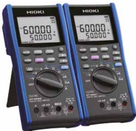
Multimetri palmari con precisione e banda passante tipica degli strumenti da laboratorio: precisione base  $\pm 0,025\%$  rdg e risposta in frequenza da 20Hz a 100k Hz (V AC). Elaborazione in Vero Valore Efficace TRMS (TRMS). Misurano la tensione raddrizzata con componenti alternata e continua sovrapposte (AC + DC) visualizzando il contributo di ogni componente, oltre a valore di picco sulla forma d'onda.
