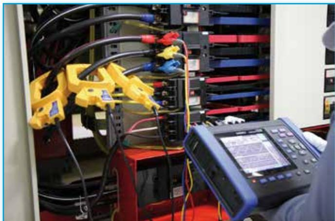
PW3198/90 è un analizzatore della qualità di rete per il monitoraggio e la registrazione di anomalie di alimentazione, che consente di individuare rapidamente le loro cause e di valutare gli effetti di disturbo presenti sui circuiti di alimentazione quali picchi e cadute di tensione, sfarfallio, armoniche e altre fluttuazioni elettriche.
